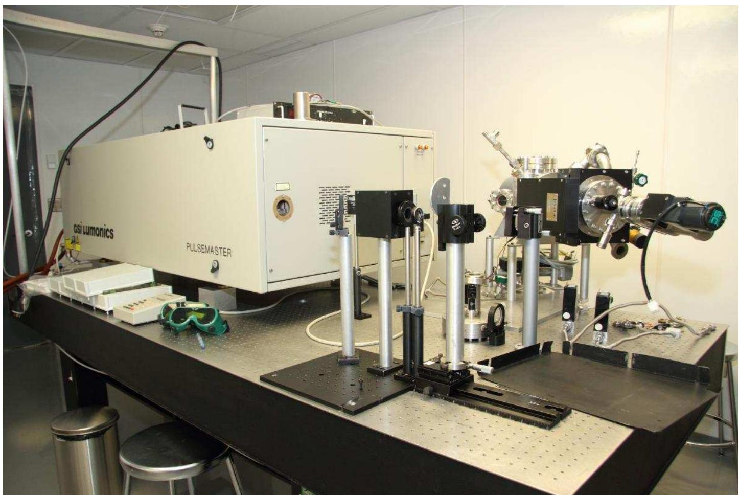
Slika 4.12 KrF 248nm excimer laser za mikroelektroniku
